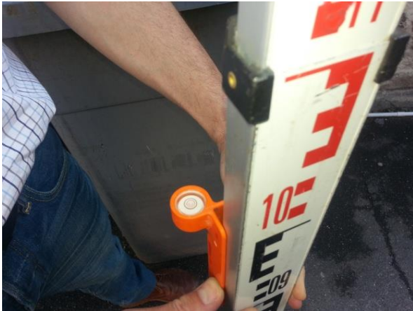
3 - Mire maintenue verticale grâce au niveau à bulle
