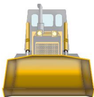
Lame de terrassement
